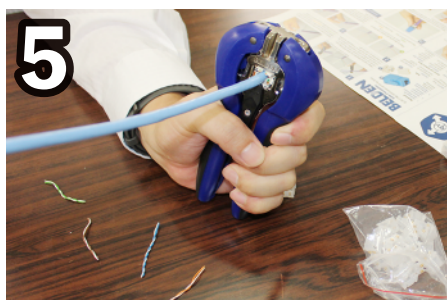
ケーブルツール (RVUTT01) にセットし圧着します。圧着の際に、余分な芯線が切断されます
