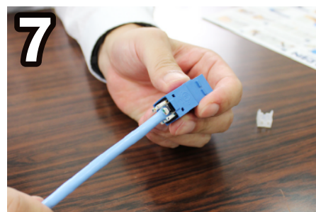
「ジャックインターフェイス」にはめ込んで完成です。もちろん、ジャックインターフェイスの取り外しや付替えも可能
