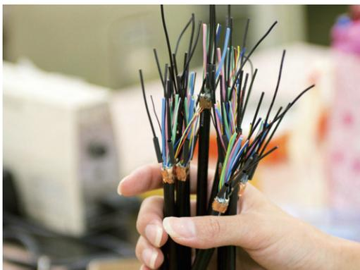
電気を用いるあらゆる製品や装置の内部に必ず使用されている「ワイヤーハーネス」。構成する電線・端子・チューブ等の材料管理はもとより、加工方法や検査工程等にも様々な規格・規則・認証が存在します。
